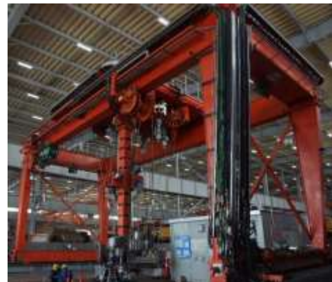
3号機 燃料取扱機
