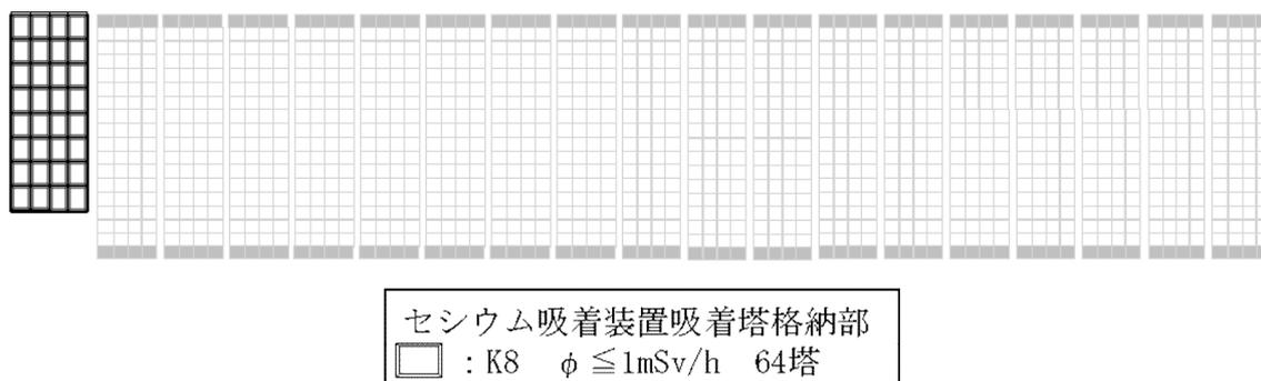
図2 第三施設の吸着塔格納配置計画 ( $\phi$  : 吸着塔側面線量率)
