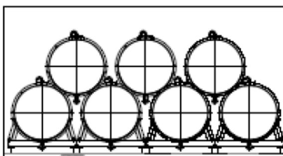
図-11 ブルータンクの仮置き状態
