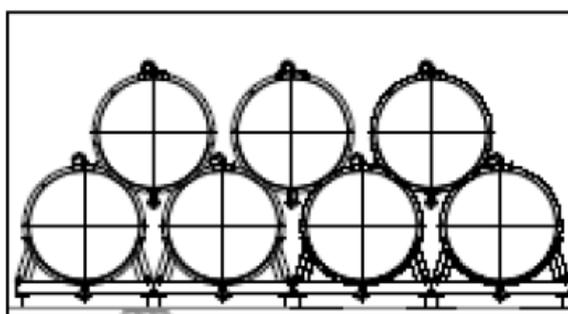
図-6 ブルータンクの仮置き状態
