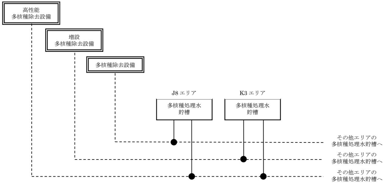
移送配管系統図 (J8, K3)
