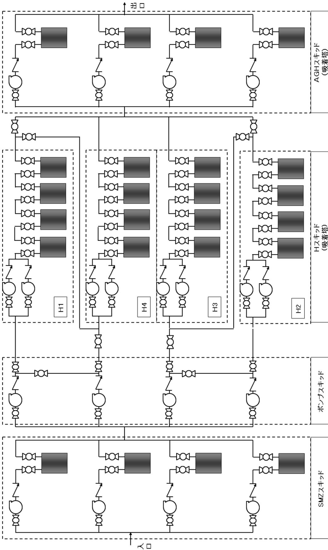
図-4 セシウム吸着装置の系統構成図
