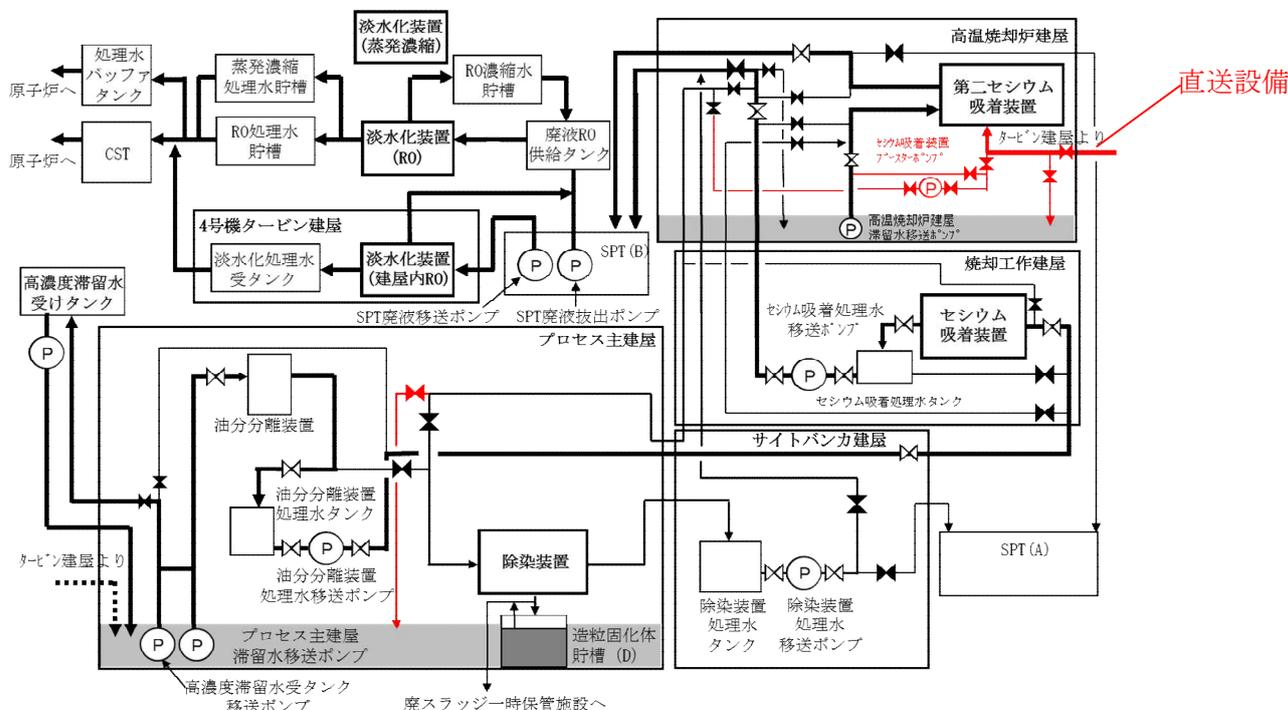
図-2 直送設備の範囲図（処理装置の系統構成図）
