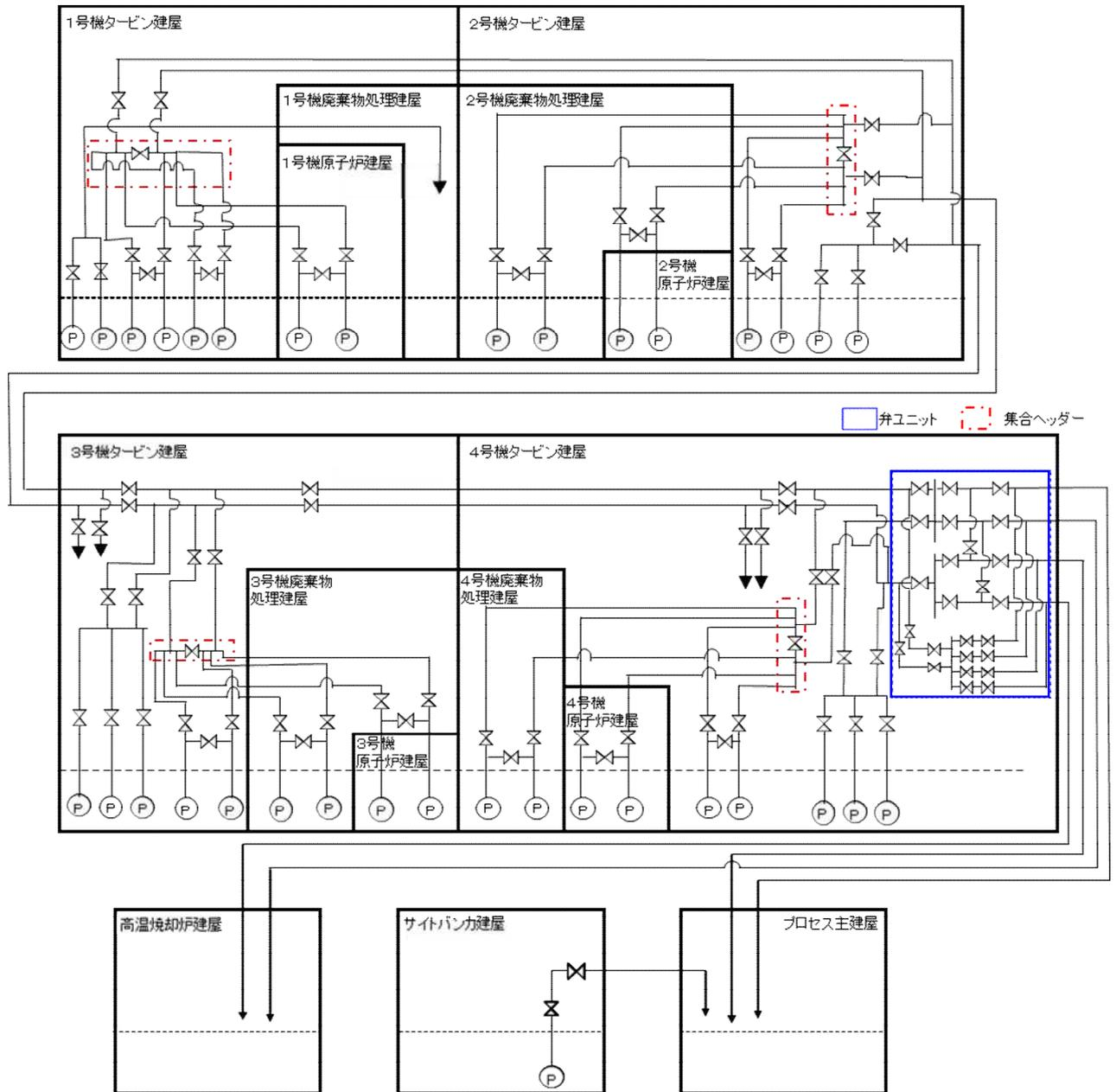
(b) 移送装置系統図概略図
