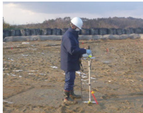
仮置場除去土壌等搬出完了後の 空間線量率測定
