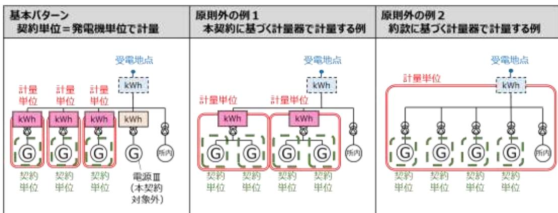
…託送供給等約款に基づく計量器 (発電量調整契約の精算用)
