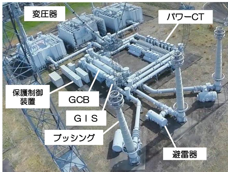
UHV機器試験場 実証試験設備の構成
