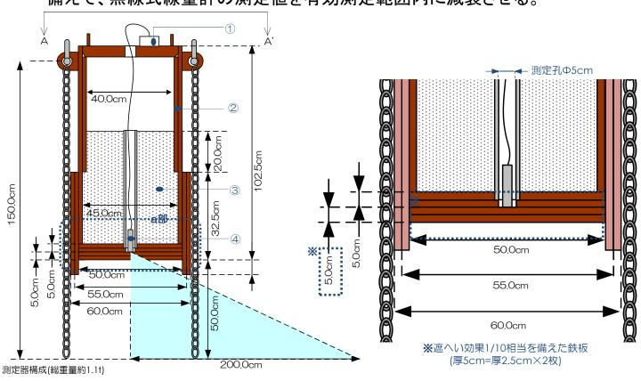
①電源・送信機箱 ②コリメータ容器(鋼製) ③コンクリート充填剤 ④無線式線量計 コリメート測定器
