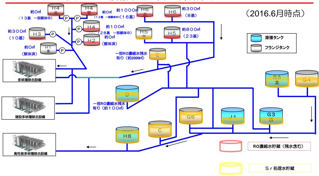
残水は、既設ポンプで移送できる約1~1.5mまで移送。 その後、仮設ポンプにて受払タンクへ移送し処理していく
