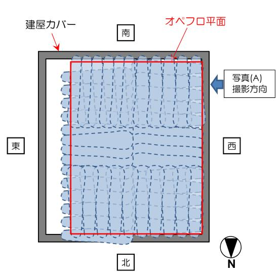
飛散防止剤散布-崩落屋根下散布平面イメージ
