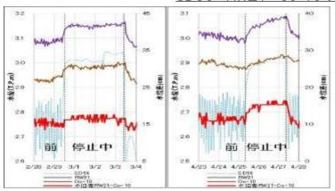
No.56サブドレン停止時の水位変動の比較 (凍結開始前・凍結開始後)
