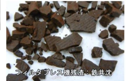
フィルタプレス機残渣: 鉄共沈
