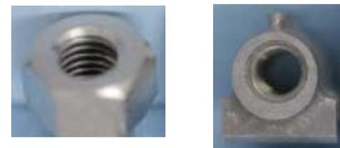
浸漬後(B型上部ロックナット、条件) 浸漬後(B型下部タイププレート、条件)
