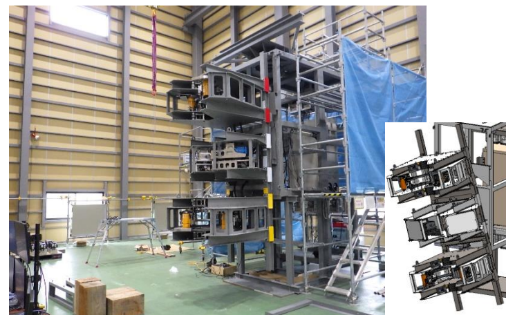
鉄塔解体装置（斜材用）組立状況
