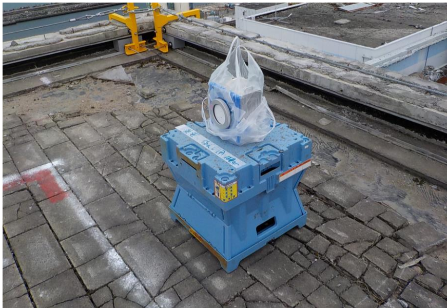
図1 有人作業時のダストサンプラによるダスト測定状況
