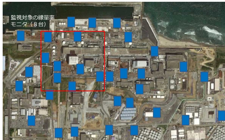
1～4号機周辺の線量率モニタ設置場所
