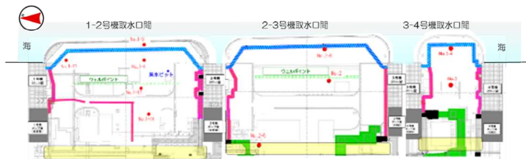
水ガラスによる地盤改良施工箇所
