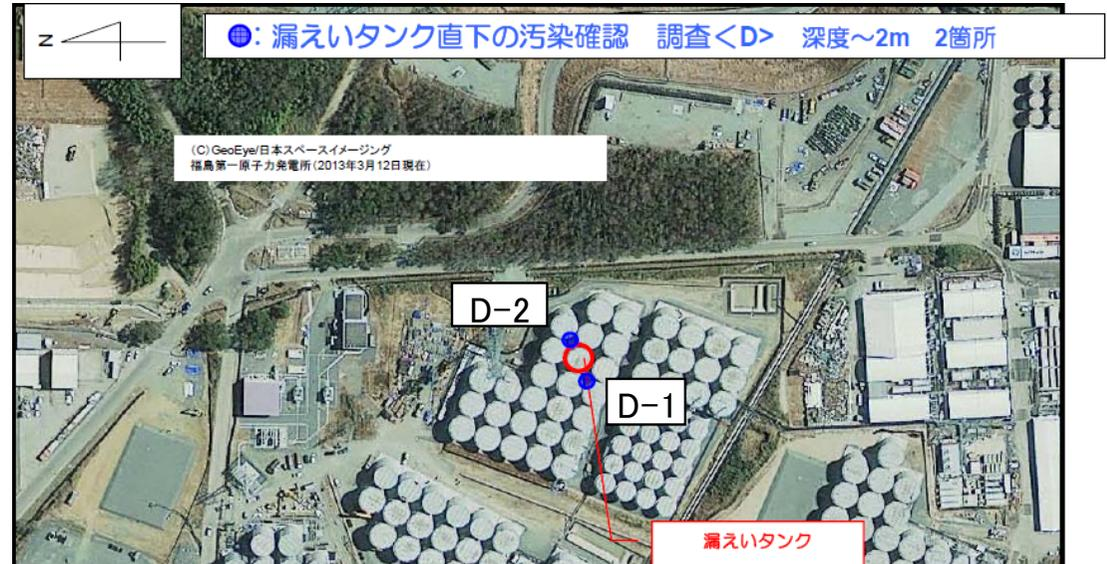
深さは地表面からの深さであり、この上に約30cmの砕石層と20cmの基礎コンクリートがある。基礎コンクリート裏面及び砕石の放射線は、B.G.レベルであった。深さ1 mまでは地盤改良を実施している。
