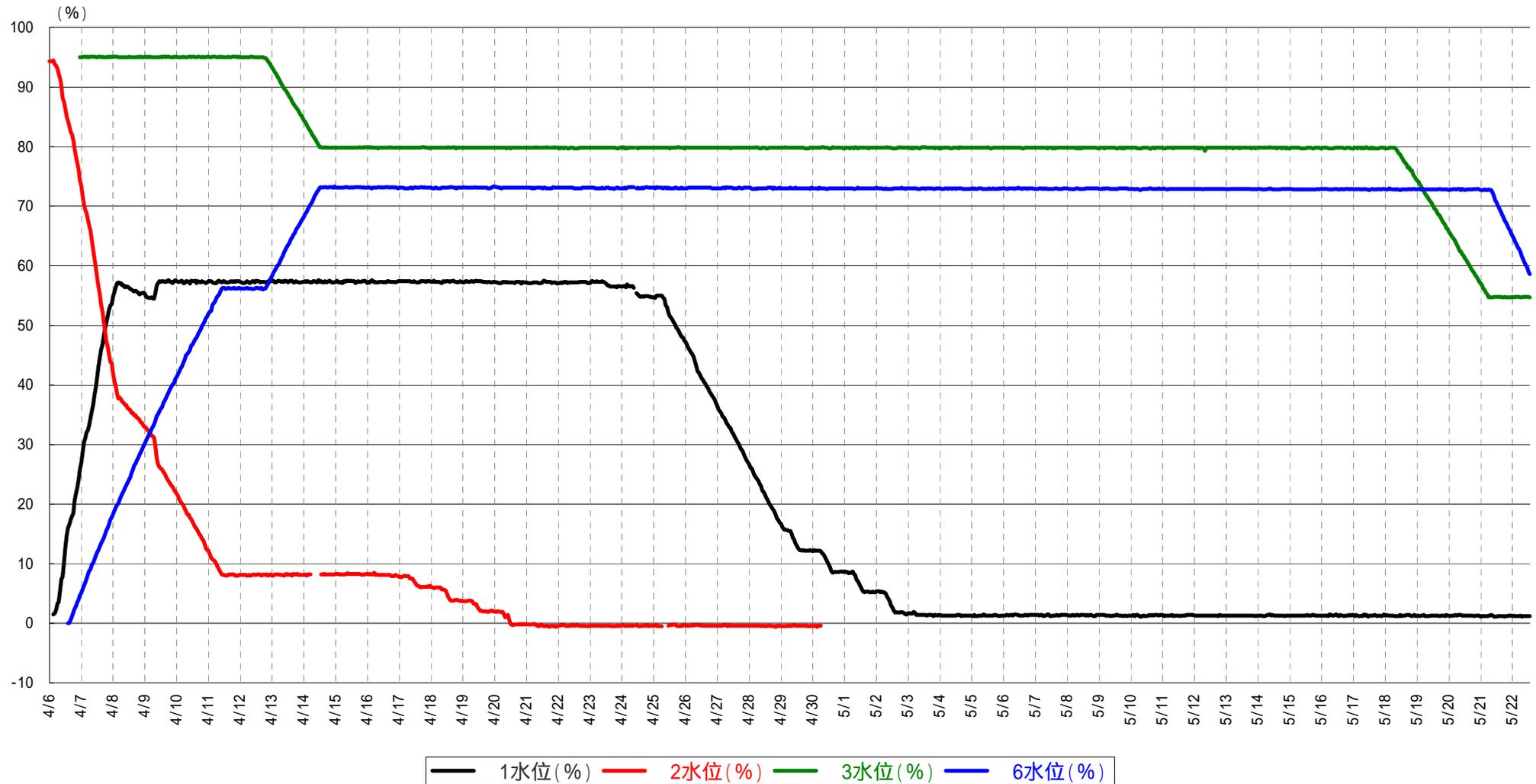
・地下貯水槽No.2の水位グラフにおいて、地下貯水槽No.2からH2エアタンクへの移送用仮設ポンプ設置に伴い、水位計の取り外し・取り付けを実施していることから、4/14 9:00 ~ 15:00の水位データは欠測。
