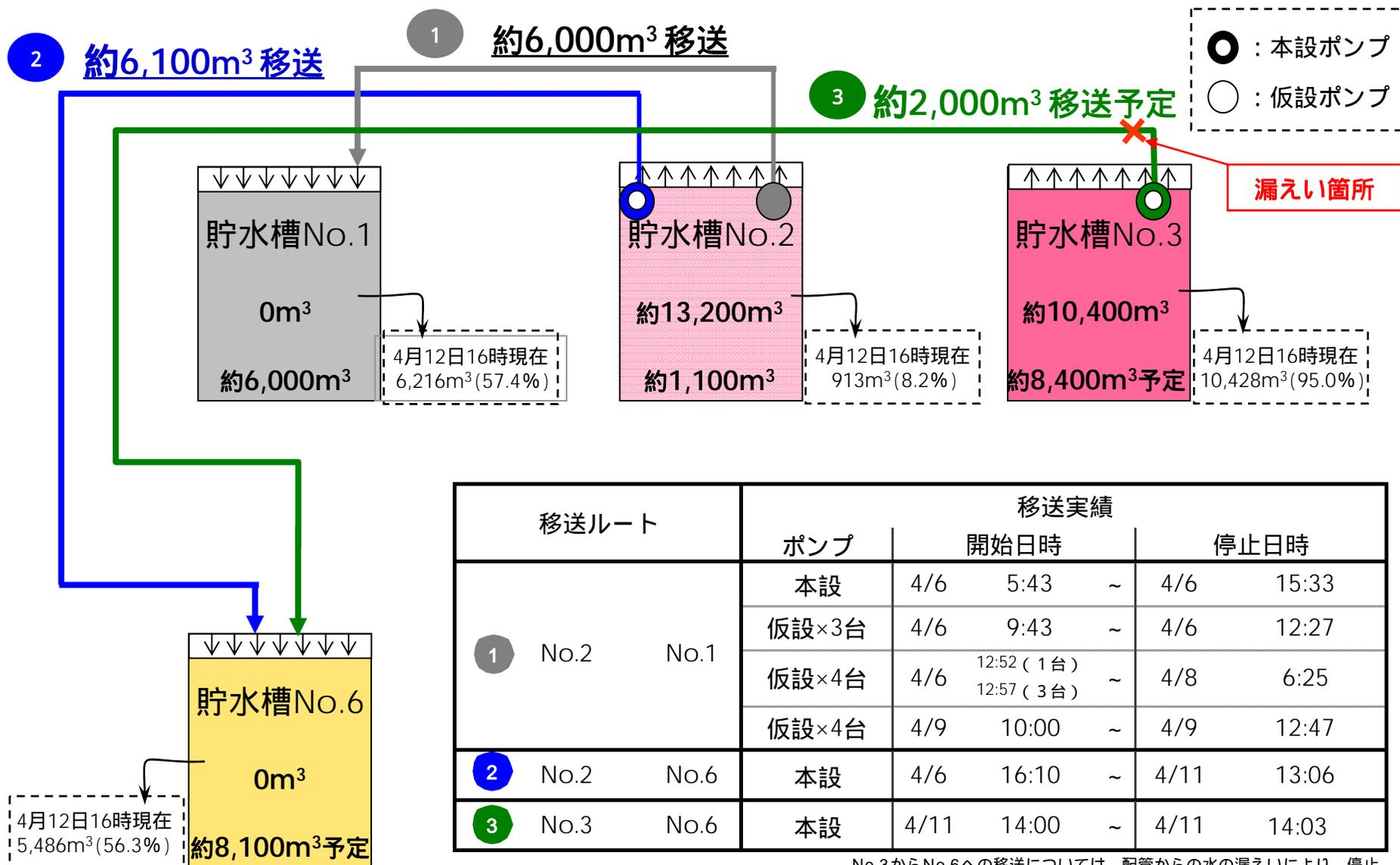
No.3からNo.6への移送については、配管からの水の漏えいにより、停止。
