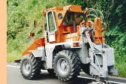
起震車B（インパクトター） （探査深度 500m程度）
