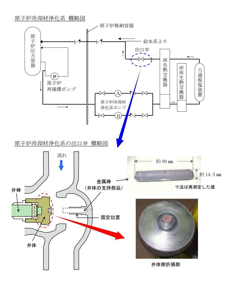
3号機原子炉シュラウド外周部から回収された金属棒の概略
