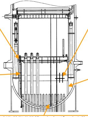
制御棒駆動機構ハウジング/案内管中性子束計測ハウジング
