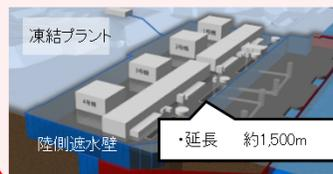
建屋への地下水流入を抑制するため、建屋を囲む陸側遮水壁の設置を計画。2014/6/2から凍結管の設置工事を実施し、2016/2に凍結設備の工事完了。2016/3より海側及び山側の一部、2016/6より山側95%の範囲の凍結を開始。
