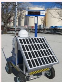
線量率モニタの設置状況
