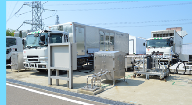
ガスタービン発電機車の配備
