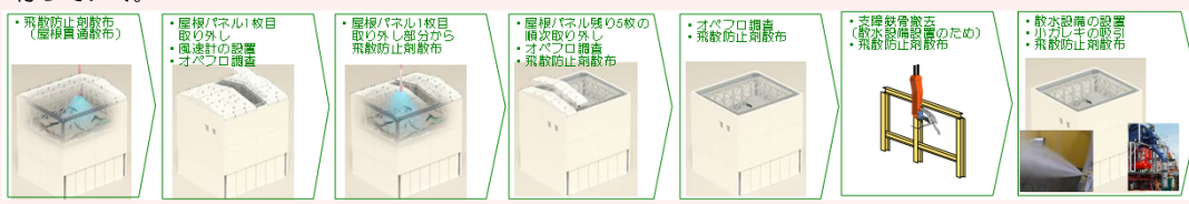
建屋カバー解体の流れ(至近の工程)
