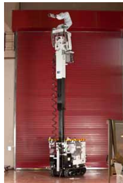
高所調査用ロボット外観
