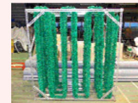
繊維状吸着材浄化装置
