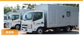
電源車は、緊急時に電源が必要な場所に移動して、 そこで発電し電気を送ることができる車です。 1~4号機側と5~7号機側それぞれの高台に 合計23台の電源車を配備しました。
