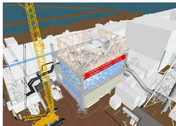
④梁取り外し※
