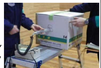
一定サイズの箱に有機廃棄物を詰め表面線量率を測定
