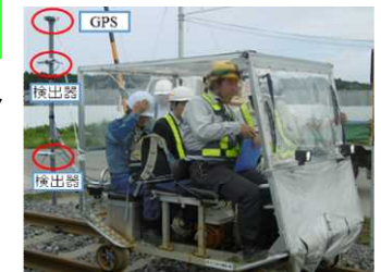
線路上モニタリングの状況
