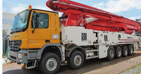
全長約16m、重さ約60tの大型車で、ブームの長さは約62m。外部より使用済燃料プールへ注水することができます。構内に3台配備しています。
