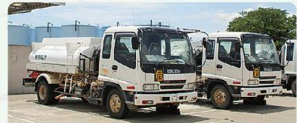
給油所までの移動が困難な大型車や発電機等への給油に使用します。構内に4kℓ 2台と880ℓ 1台のタンクローリーを配備しています。
