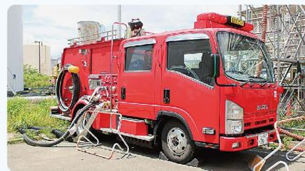
消防車のホースを原子炉冷却配管に接続し放水することで、原子炉へ注水することができます。構内に3台配備しています。
