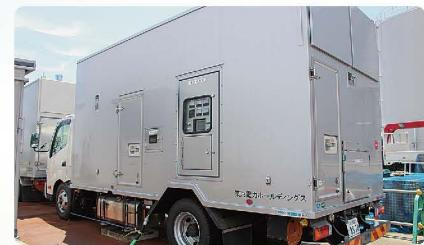
軽油を燃料とし、約2時間(満タン時)の発電が可能です。主に所内電源設備の電源として使用します。構内に6台配備しています。
