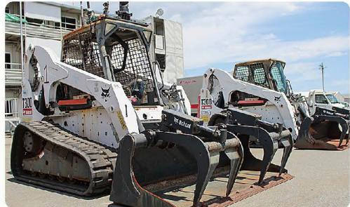
散乱したガレキを撤去し、緊急時のアクセスルート確保のため使用します。構内に2台配備しています。
