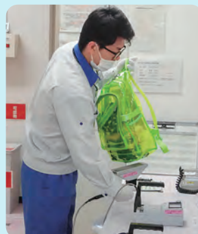
携行品モニタに入らない大きな携行品は、測定員による汚染検査を行います
