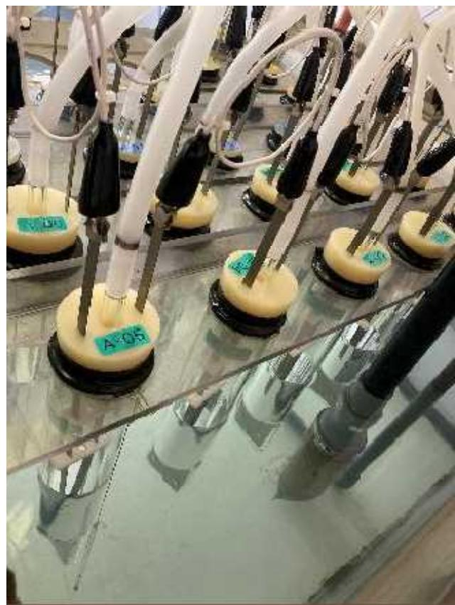
図 2.6 金属電極を用いた電解濃縮の様子
