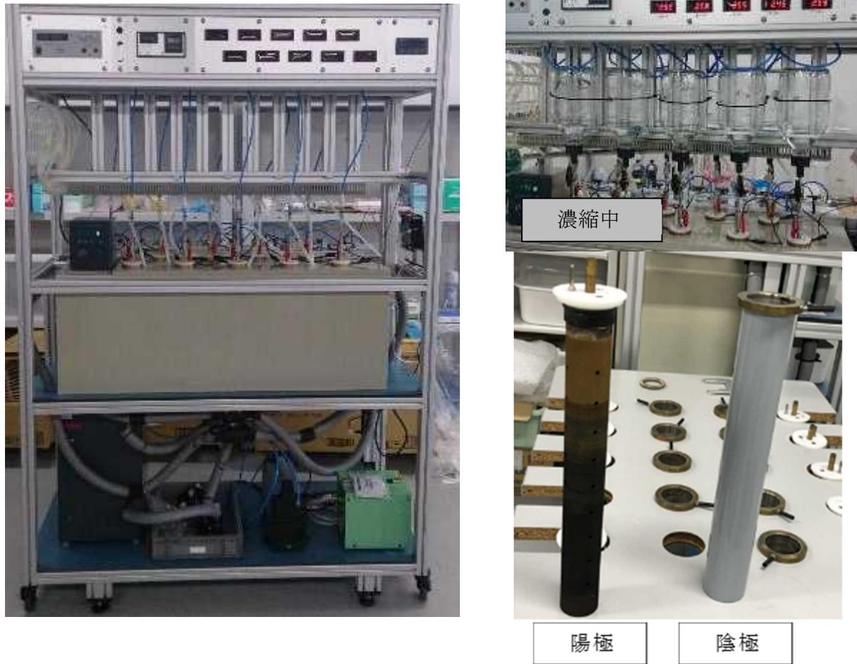
図 A.2 装置と電極の外観
