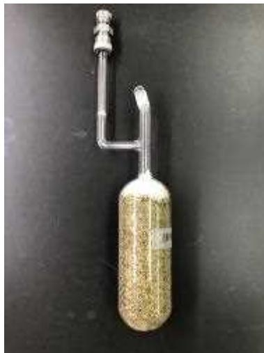
参図 D.2 生物試料を封入した密閉容器
