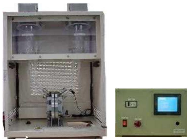
図 2.9 固体高分子電解濃縮装置の外観
