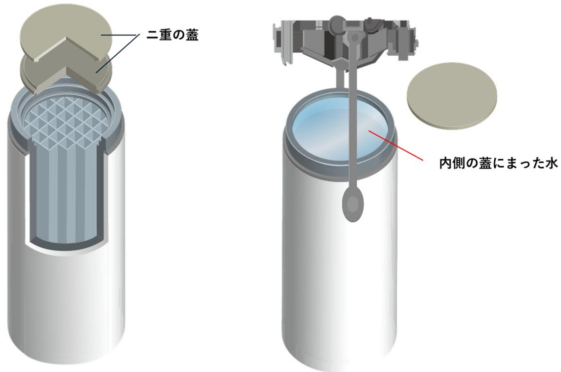
乾式キャスクは二重蓋構造で、プール内で内側の蓋を閉めた状態で引き上げると、上部には水が溜まる構造となっています。
