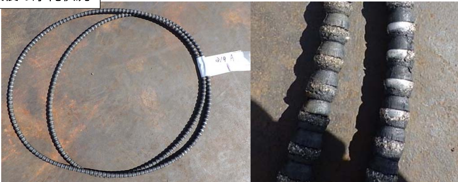
対策後の摩耗状況
