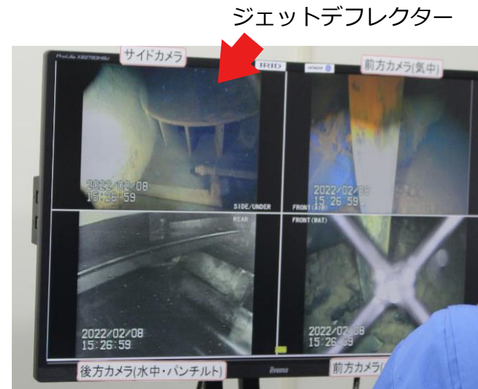
写真4.PCV底部(水中)の様子
