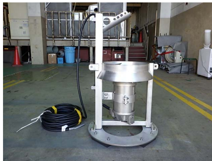
(攪拌装置側面部)
