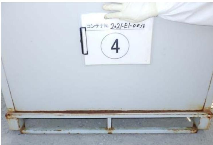
写真3.側面下部に著しい腐食があるコンテナ
