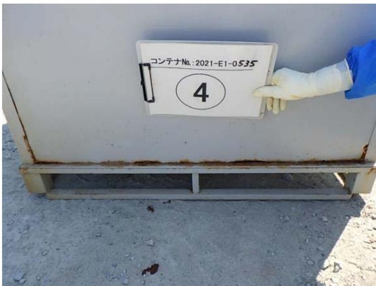
写真1.側面下部に著しい腐食があるコンテナ
