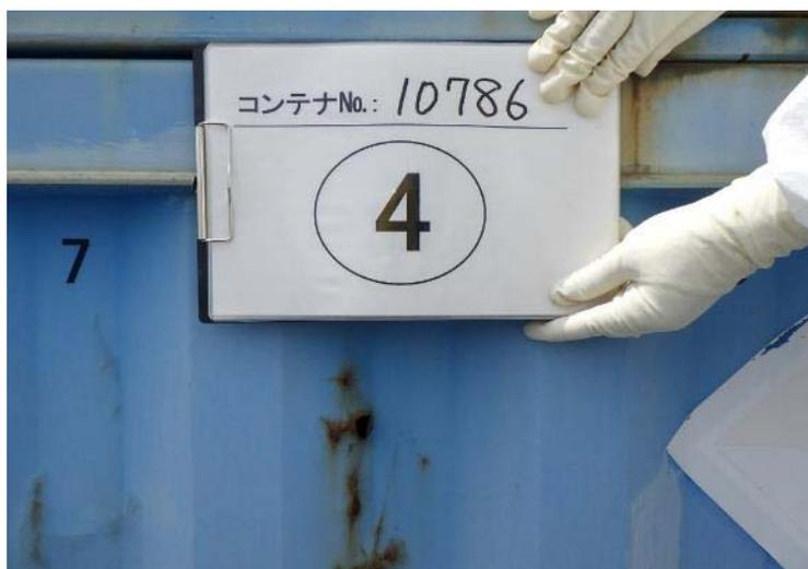
写真7.側面に著しい腐食があるコンテナ
