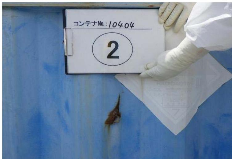
写真5.側面に著しい腐食があるコンテナ
