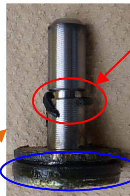
図3.当該弁のピストン部品 (損傷が確認されたOリング)
