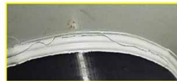
フランジ部付け根の割れ (漏えい箇所)
