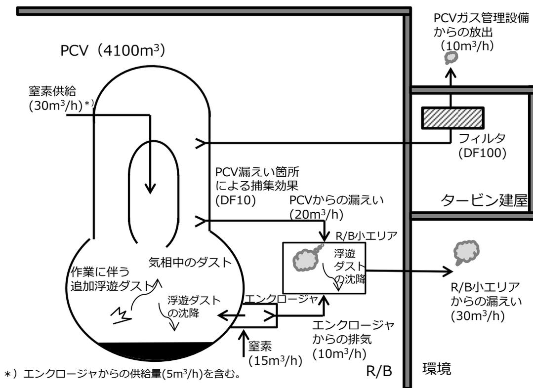
図2 通常時放出量評価モデル
