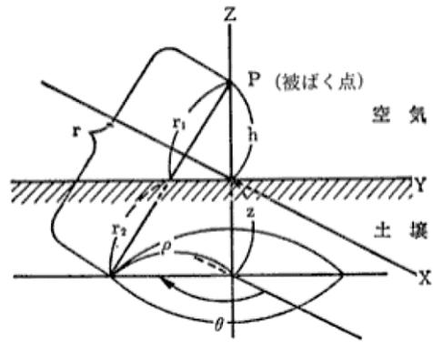
図 2. 2. 1-2 沈着評価モデル
