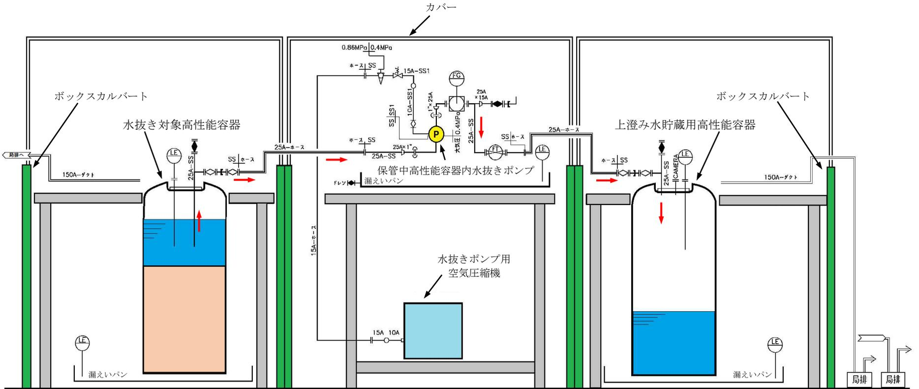
図2 保管中高性能容器内水抜き装置概要図
