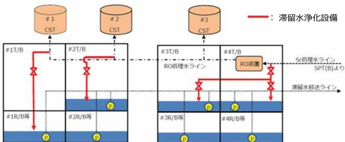
図－ 1 滞留水浄化設備の設置範囲
