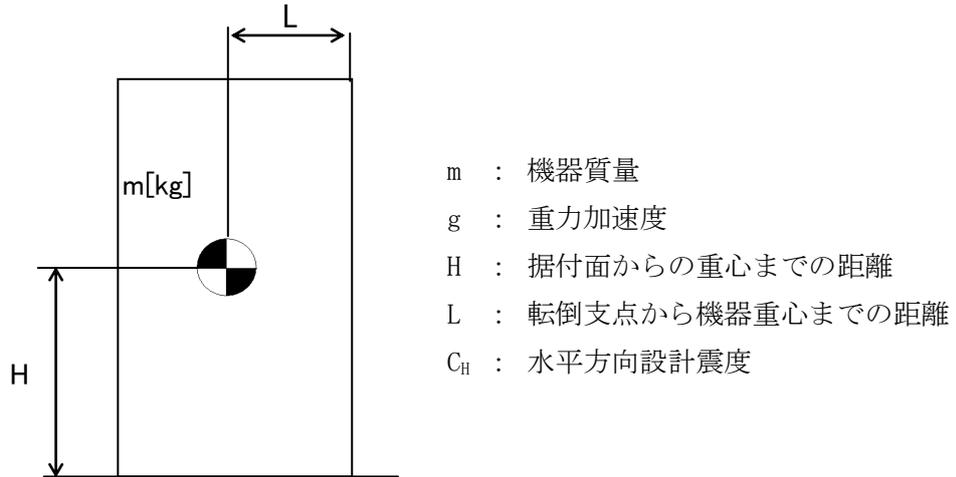
地震による転倒モーメント： $M_1$  [N・m] =  $m \times g \times C_H \times H$
