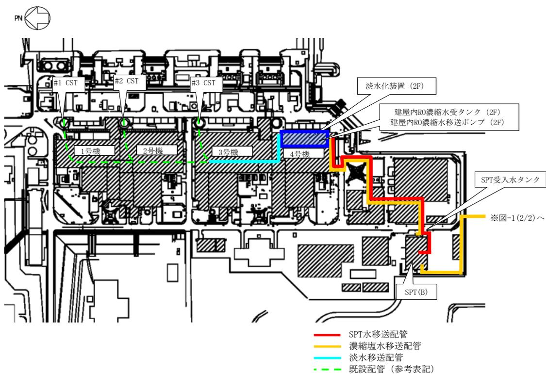
図-1 建屋内 R0 循環設備および追設する関連機器の配置概略図 (1 / 2)
