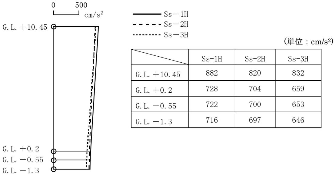
図-11 最大応答加速度 (NS 方向)
