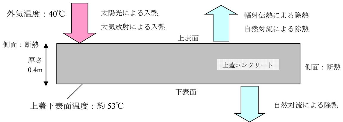
図3 太陽光からの入熱によるボックスカルバート上蓋の温度評価体系の概念
