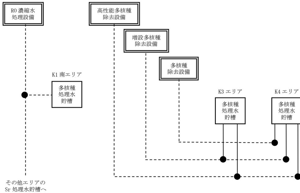
移送配管系統図 (K1南, K3, K4)
