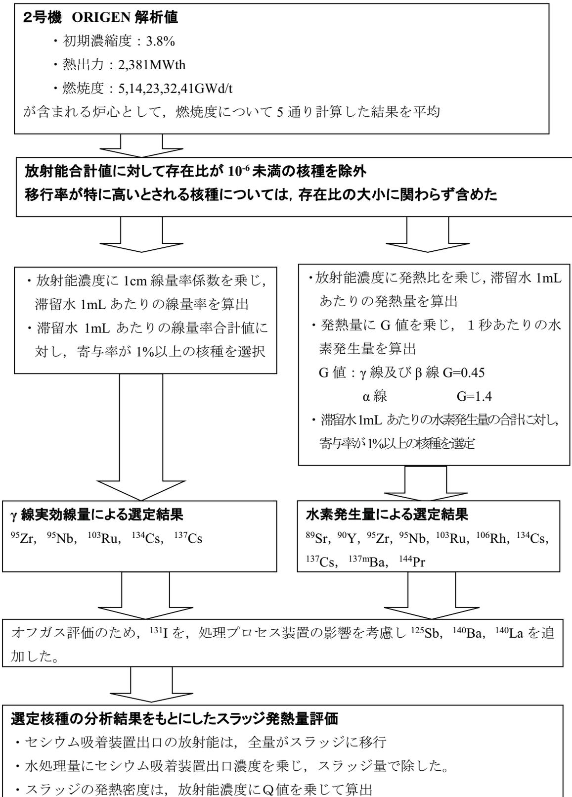
図-1 スラッジ崩壊熱算定の流れ
