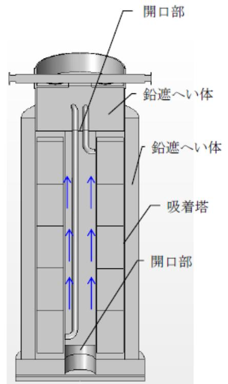
図-4 (TYPE-B) 同時吸着塔
