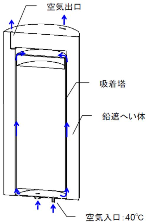
図-3 (TYPE-A) 同時吸着塔
