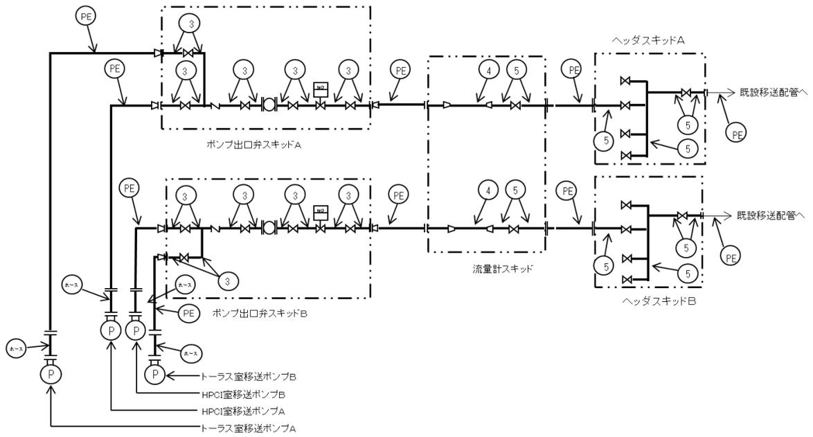
図-1 配管概略図 (7 / 12)
