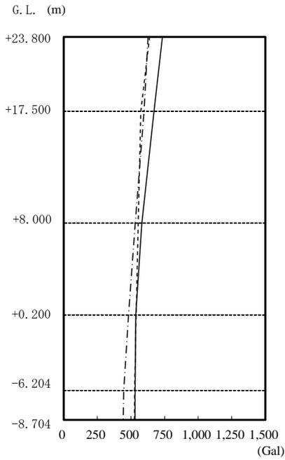
図 5-1 最大応答加速度
