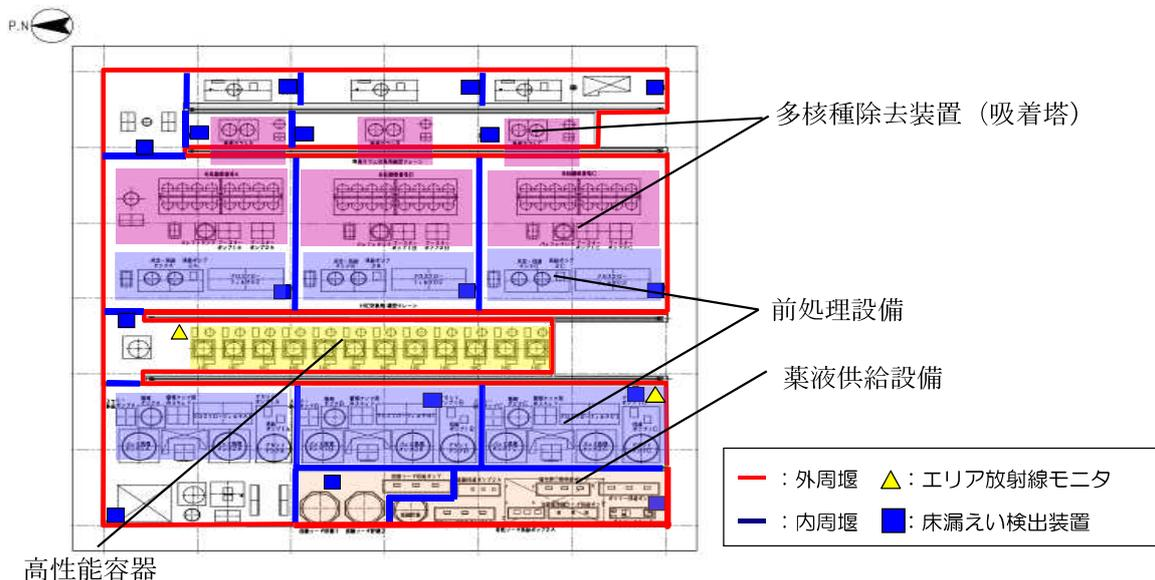
図1 堰及び床漏えい検出装置
