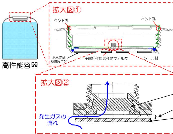
収容物には粘性があるほか、以下の3重構造により、フィルタエレメントへの収容物（液体）の飛散を防止する設計としていることから、フィルタが閉塞することはない。
