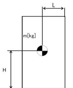
$C_H$  : 水平方向設計震度
