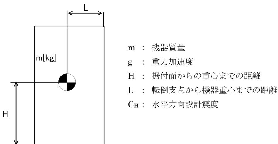
地震による転倒モーメント： $M_1 [N \cdot m] = m \times g \times C_H \times H$
