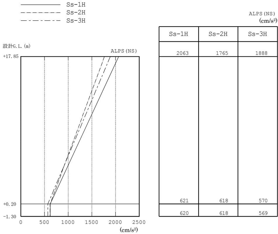
図-13 最大応答加速度 (NS 方向)
