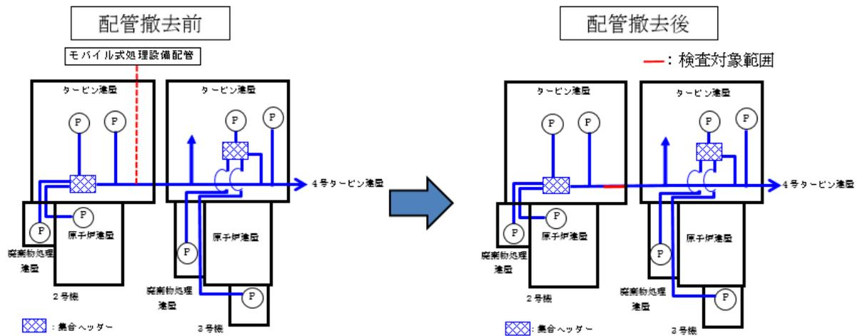
図－2 滞留水移送装置 検査範囲図
