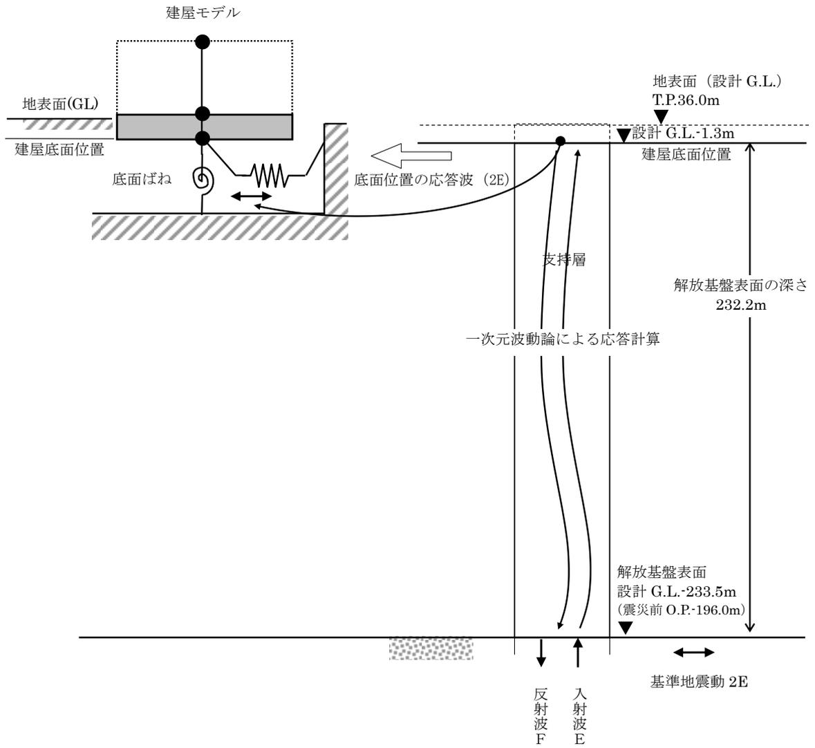
図一 8 地震応答解析に用いる入力地震動の概念図 (水平方向)
