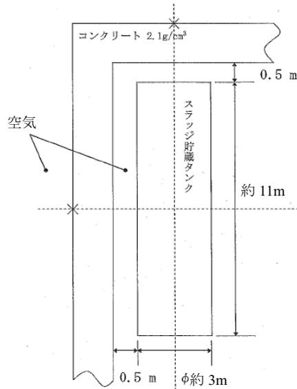
図－1 廃スラッジ一時保管施設 建屋外壁評価モデル
