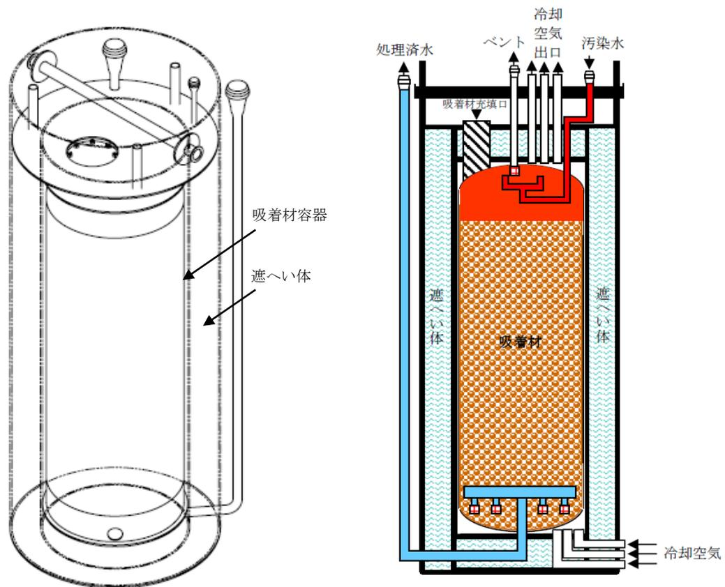
図-1 (1/3) 同時吸着塔外形図及び概念図 (TYPE-A)
