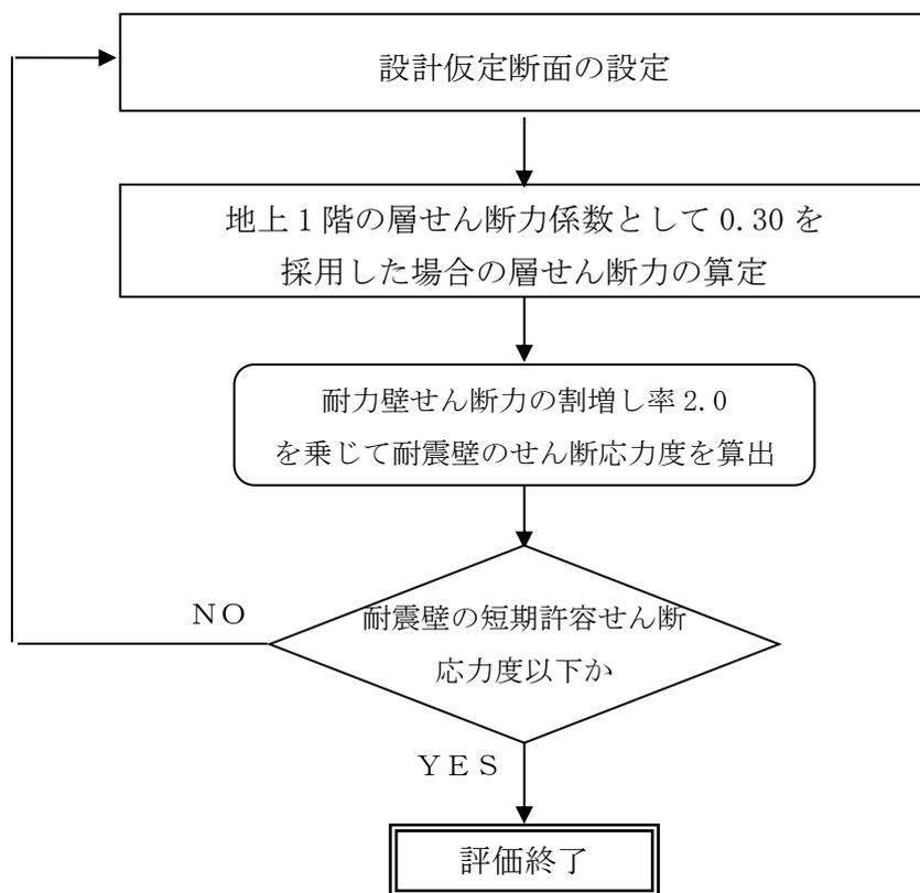
図-5 建屋の耐震安全性評価手順
