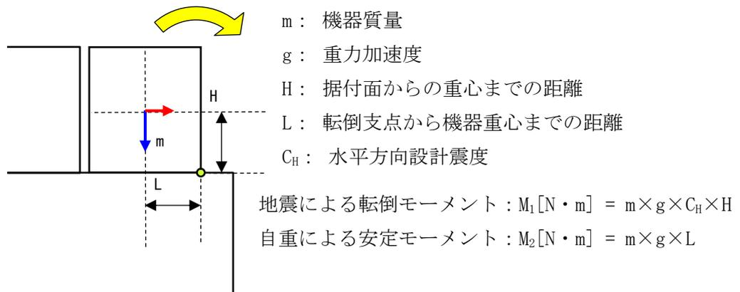
表－1 仮置きタンクの転倒評価結果
