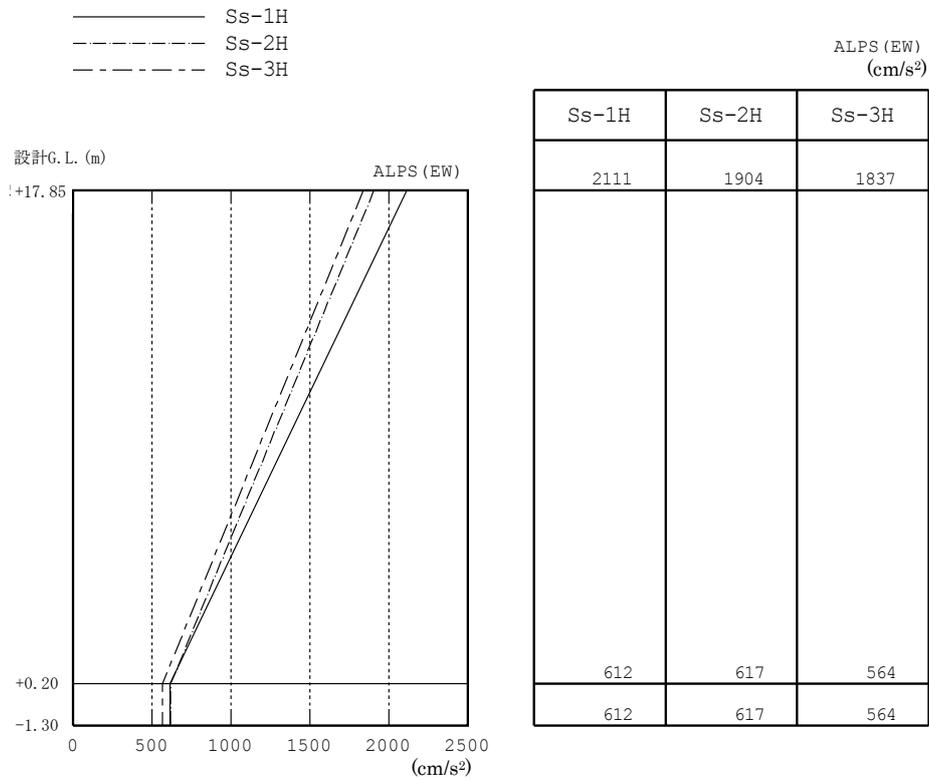
図-14 最大応答加速度 (EW 方向)
