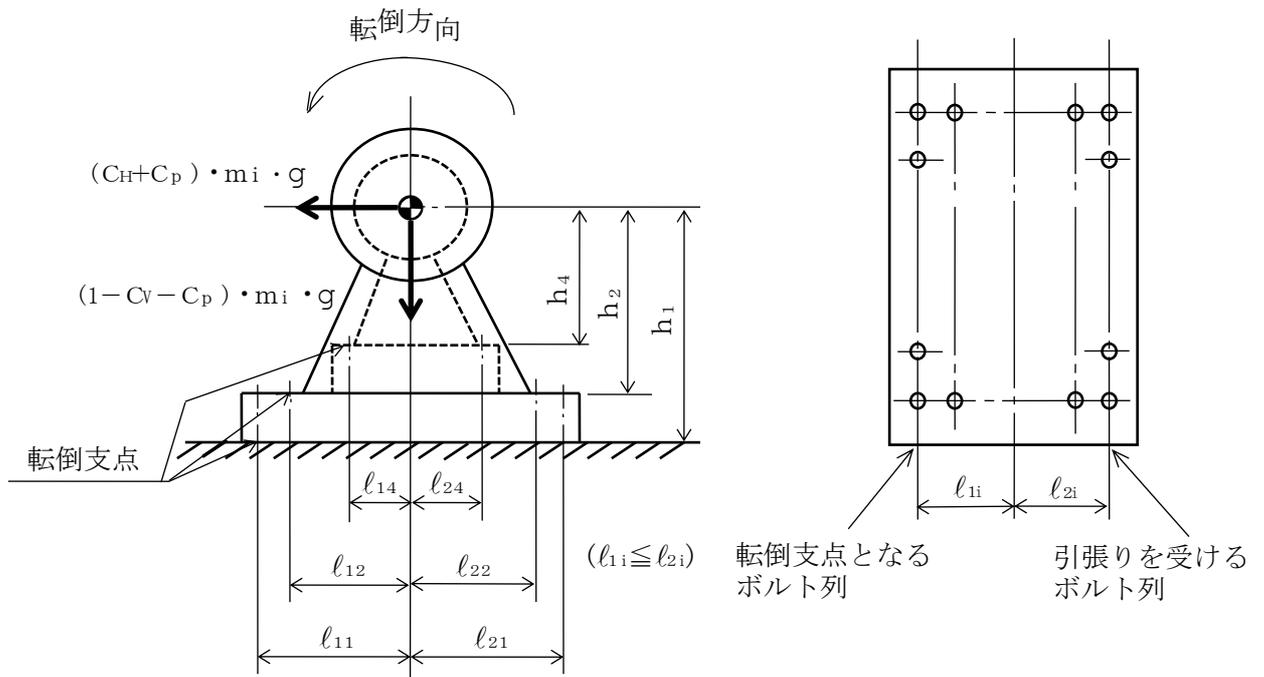
図 2-1 計算モデル (軸直角方向転倒)
