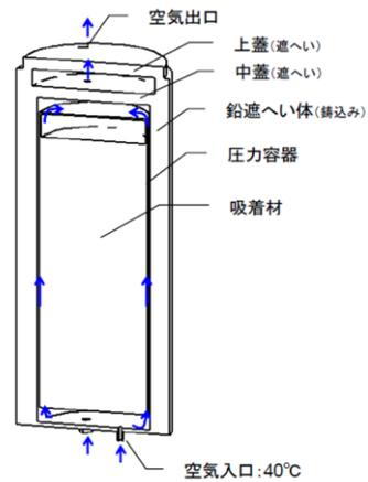
図1 吸着塔A型解析モデル（概念図）
