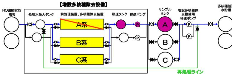
【STEP1：A系隔離、B/C系による系統洗浄】
