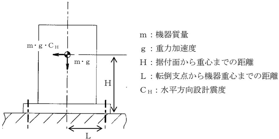
地震による転倒モーメント： $M_1 = m \times g \times C_H \times H$
