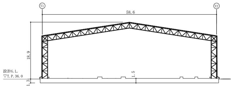
図-4 B-B断面図 (EW 方向) (単位 : m)
