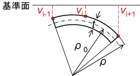
$v_i$ : 底板各点の基準面からの垂直方向距離測定値
