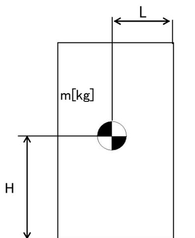
$C_H$  : 水平方向設計震度
