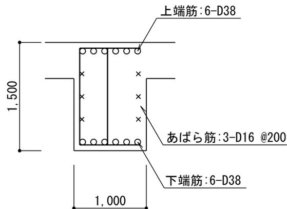
図 3-2 大梁配筋図 (単位：mm)
