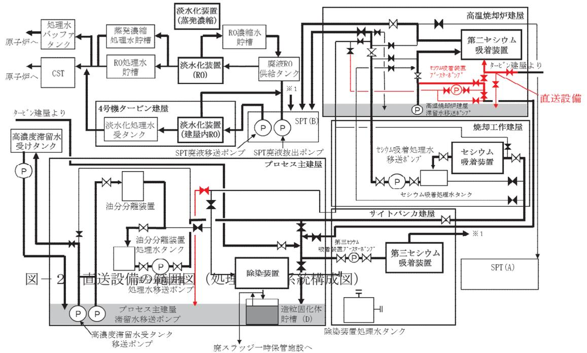
図-2 直送設備の範囲図（処理装置全体系統図）
