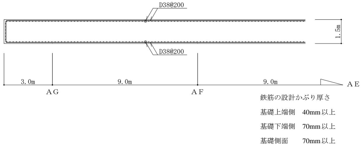
図-6 基礎スラブ配筋図 (A1 通り)
