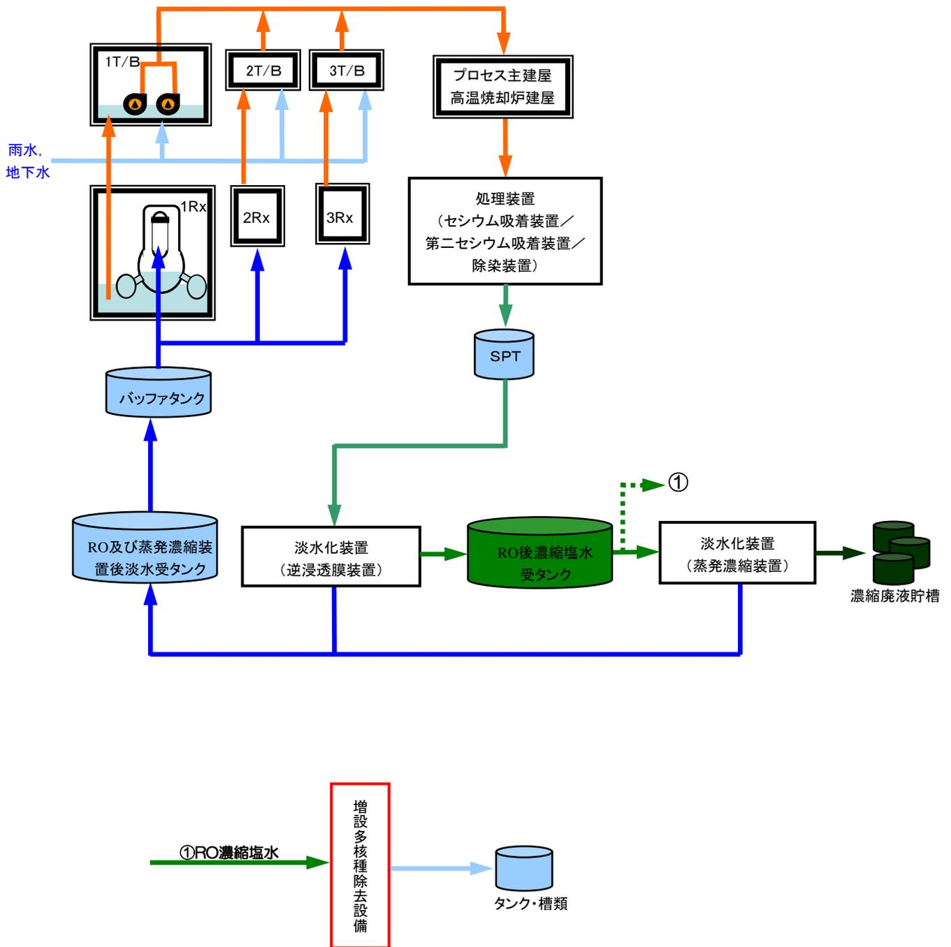
図-1 汚染水処理設備並びに増設多核種除去設備等の全体概要図
