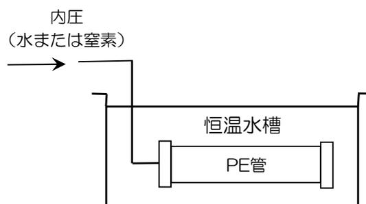
図1. 熱間内圧クリープ試験の概念図
