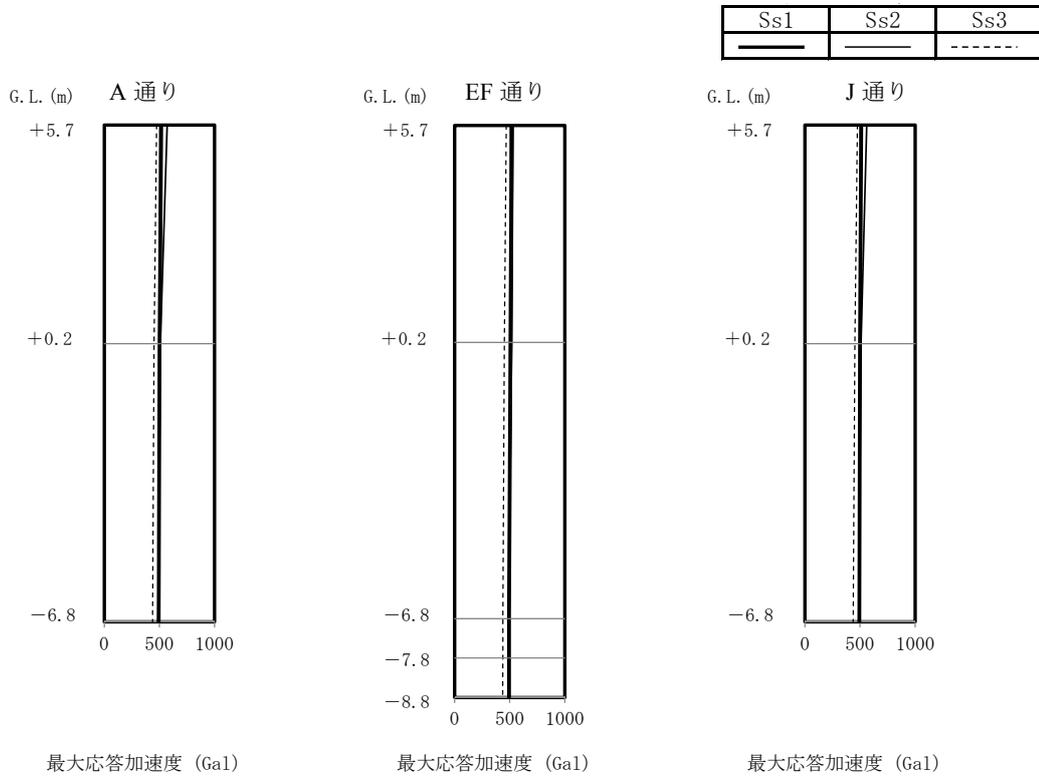
図5-1 最大応答加速度 (NS方向)
