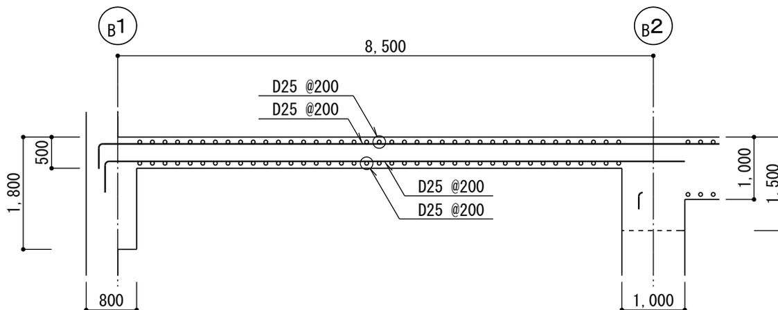
図 3-1 床スラブ配筋図 (単位: mm)
