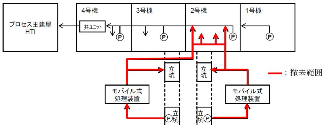
図－1 モバイル式処理設備 撤去範囲
