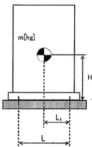
L：基礎ボルト間の水平方向距離
