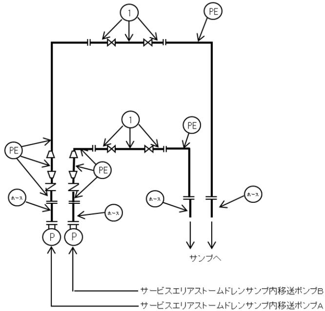
図-1 配管概略図 ( 1 2 / 1 2 )
