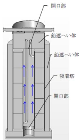
図3 吸着塔B型解析モデル（概念図）
