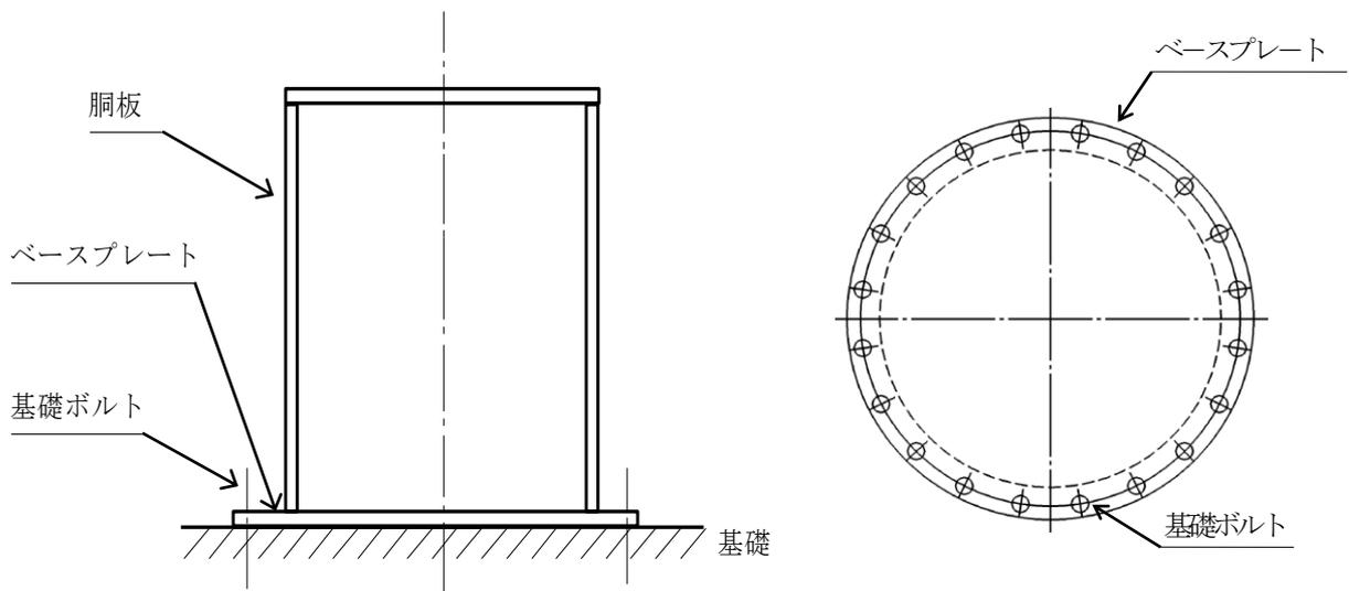
図1-1 平底たて置円筒形容器の概要図
