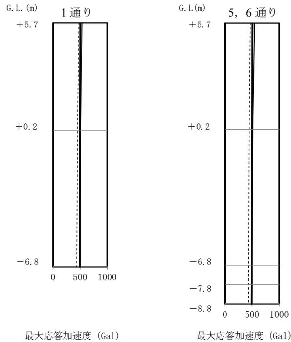
図5-2 最大応答加速度 (EW方向)
