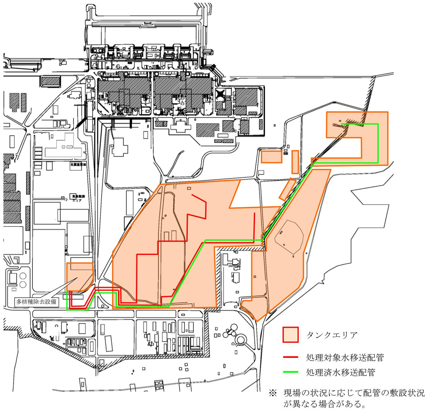
図-2 多核種除去設備の配置概要図
