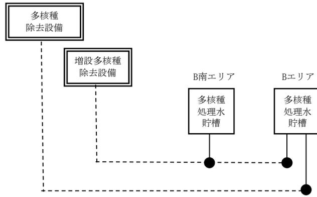
移送配管系統図 (B, B 南)
