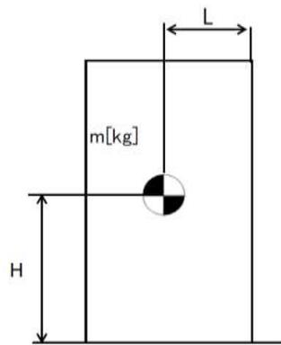
$C_H$  : 水平方向設計震度
