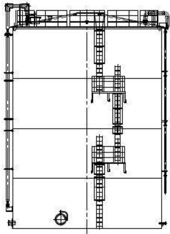
溶接型タンク概略図 (H4 南(1, 140m<sup>3</sup>))
