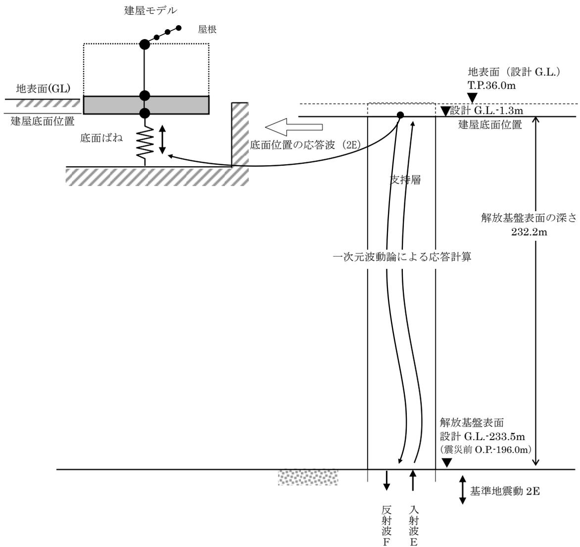
図一 9 地震応答解析に用いる入力地震動の概念図（鉛直方向）
