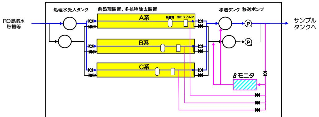
図3  $\beta$ モニタシステムの概要
