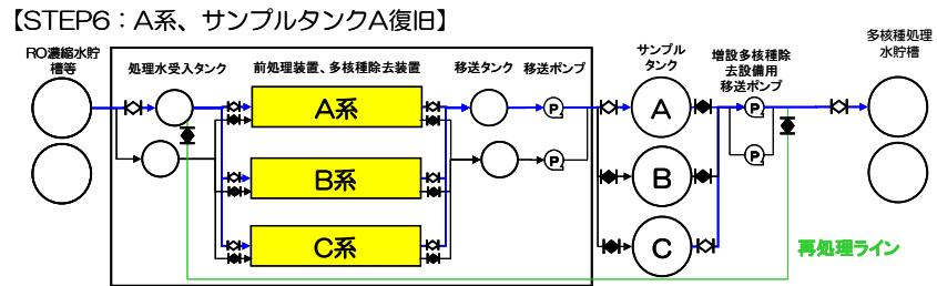
図2 汚染発生時の対応ステップ（2／2）
