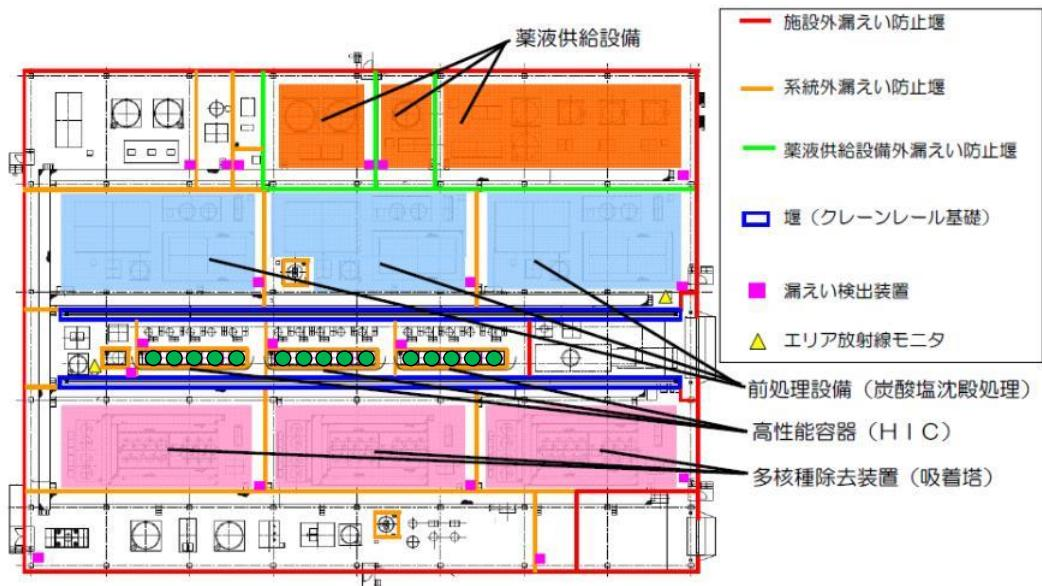
図1 壁及び漏えい検出装置
