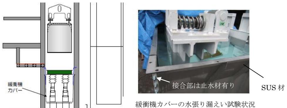
図 8 吊上げシャフト内緩衝機カバー概要
