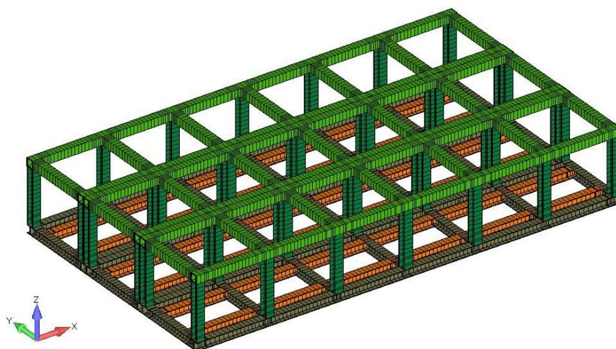
図 3. 2-1 使用済吸着塔保管架台のみの地震応答解析モデル
