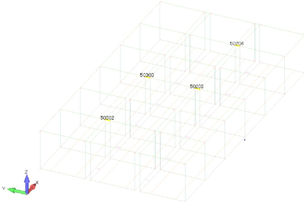
図 3.7-8 接続ボルト応力最大位置（解析モデル(吸着塔保管状態)）
