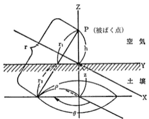
図 2. 2. 1-2 沈着評価モデル
