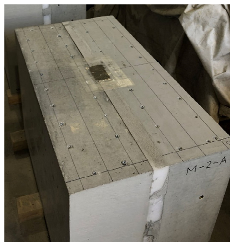
手順 5 : 止水材 (モルタル) 注入完了
