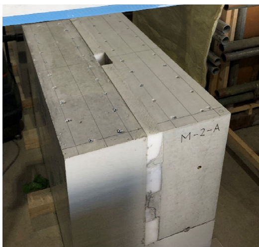
手順 4 : 注入箇所除去
