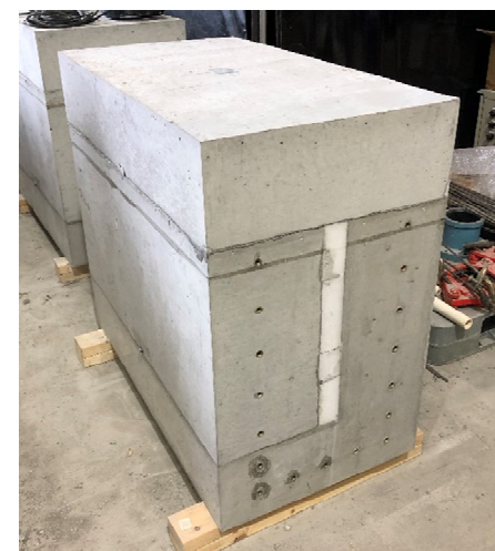
手順 6 : 上部設置 (試験体完成)
