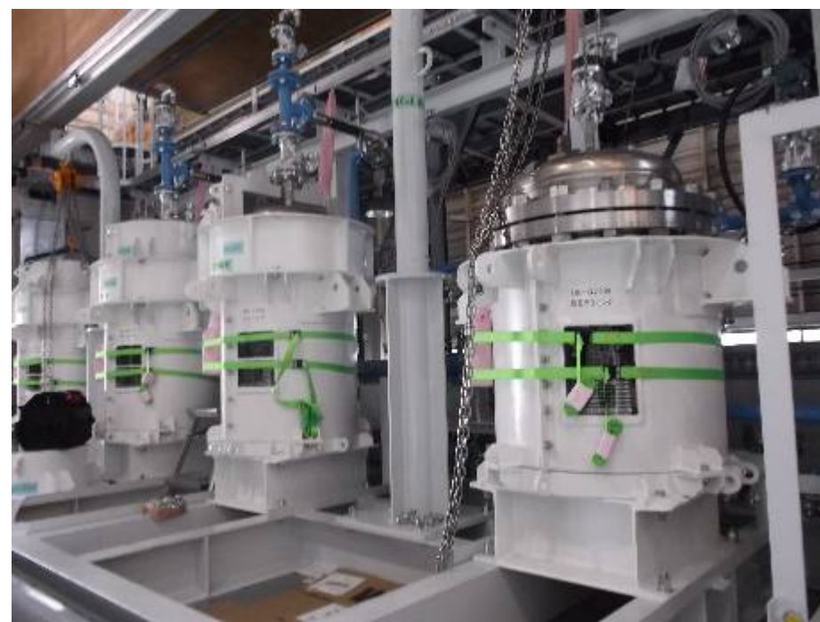
検証試験装置用フィルタ
