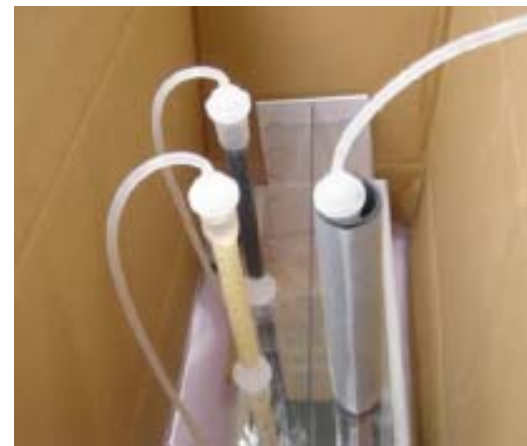
吸着除去性能確認試験装置
