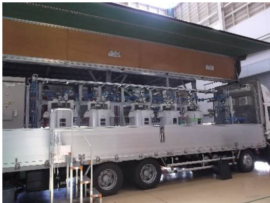
検証試験装置用吸着塔ユニット
