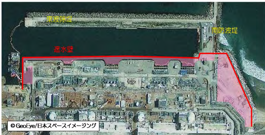
[海側遮水壁の配置図(出典:東京電力)]
