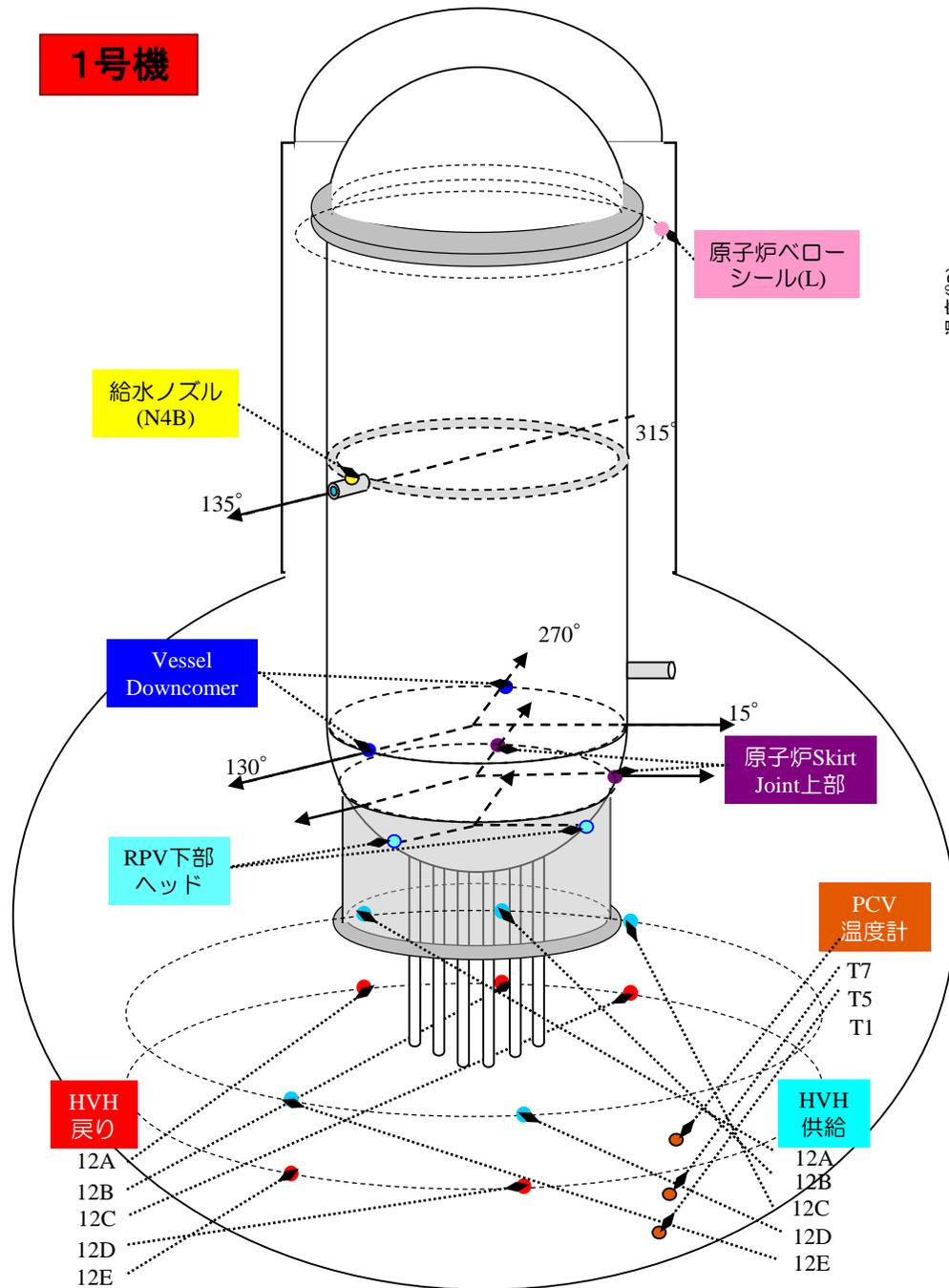
1号機 原子炉圧力容器まわり温度 (11/1~5/27)
