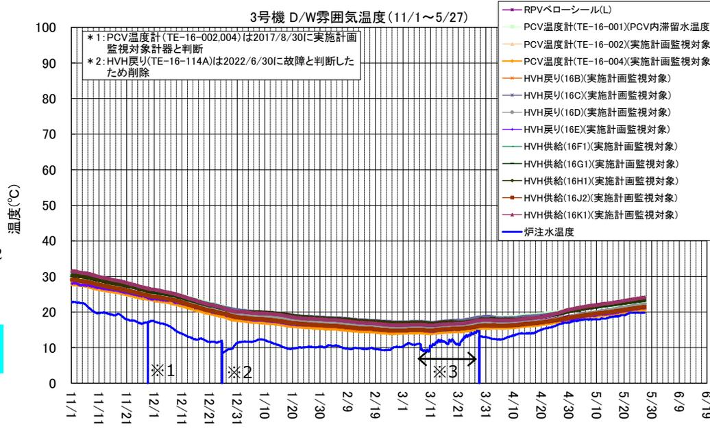
※1 2024/11/28 高台炉注水設備点検終了に伴う漏えい確認による一時的な炉注水停止のため、データが欠測
