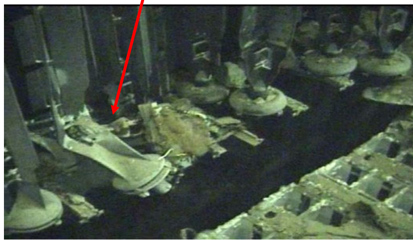
制御棒下部に変形
