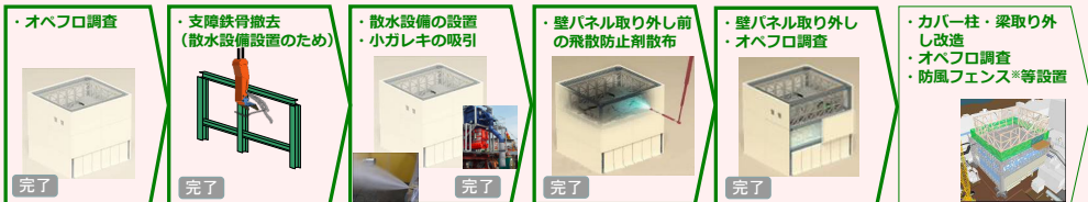
建屋カバー解体の流れ（至近の工程）
