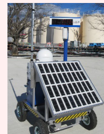
線量率モニタの設置状況
